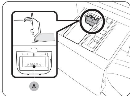
Insérez d'abord le guide à lessive liquide fourni dans le **compartiment de lavage principal**. Versez ensuite de la lessive liquide dans le guide en veillant à ne pas dépasser le **trait de remplissage maximum (A)**.
