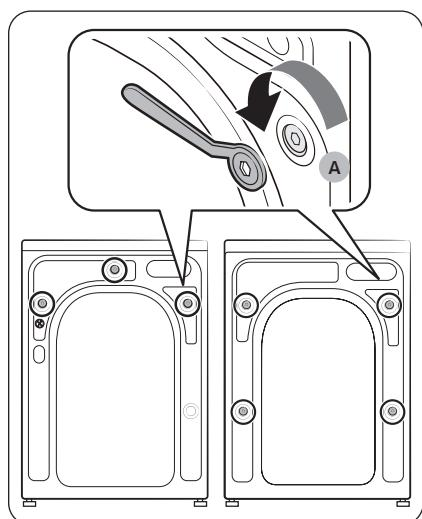
1. Repérez les boulons de transport (entourés sur l'illustration) situés à l'arrière du lave-linge.
