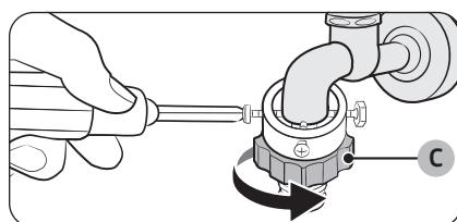
4. Insérez l'adaptateur sur le robinet d'eau, puis serrez les vis tout en soulevant l'adaptateur.
