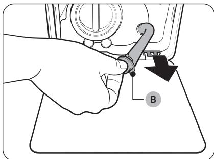
4. Ouvrez le bouchon du tuyau et laissez l'eau s'écouler du **tuyau de vidange d'urgence (C)** dans le bac.
