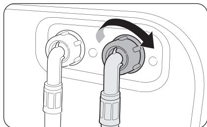
1. Raccordez l'extrémité rouge du tuyau d'eau chaude à la vanne d'arrivée d'eau chaude située à l'arrière de l'appareil.
