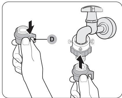
6. Tout en tirant la **partie (D)** vers le bas sur le tuyau d'eau, raccordez le tuyau d'eau à l'adaptateur. Ensuite, relâchez la **partie (D)**. Le tuyau s'enclenche dans l'adaptateur en émettant un son.
