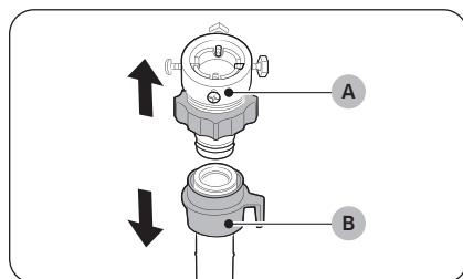
1. Retirez l'adaptateur (A) au niveau du tuyau d'eau (B).
