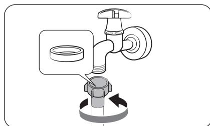
1. Raccordez le tuyau d'eau au robinet d'eau, puis tournez le raccord dans le sens horaire comme indiqué.
