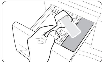
4. Pour effectuer un prélavage, versez une dose de lessive de prélavage dans le **① compartiment de prélavage** en suivant les instructions ou recommandations du fabricant.
