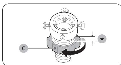
3. Maintenez l'adaptateur en place et tournez la partie (C) dans le sens de la flèche pour le desserrer de 5 mm (\*).
