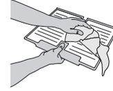
6. Laita lisävaruste paikalleen asettamalla sen takaosa kuvassa näkyvien ulokkeiden päälle, kiinnitä sitten lisävarusteen kahva yllä oleviin hakasiin.
