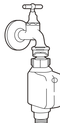
tuyau d'arrivée d'eau de sécurité
