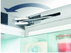
Ce système de fermeture intégré à la porte est un amortisseur par fluide qui amortit ou entraîne la fermeture de la porte y compris lorsque celle-ci est pleine. Ce système garantit une fermeture automatique parfaite et en douceur dès que l'angle atteint environ 45°. Il assure une grande sécurité et un grand confort d'utilisation.
