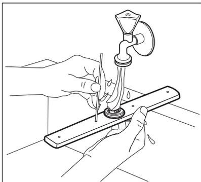
4. Pour réinstaller le bras d'aspersion, insérez la fixation dans le bras d'aspersion et insérez-le dans le conduit en le tournant vers la gauche. Assurez-vous que la fixation se verrouille correctement dans la bonne position.
