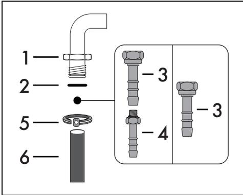
Vissez minutieusement l'embout 3 sur le raccord du gaz 1 (filet  $\frac{1}{2}$ " ISO 228-1) de l'appareil en interposant le joint 2. Suivant le diamètre du tuyau du gaz utilisé, on peut également visser l'embout 4 sur l'embout 3.
