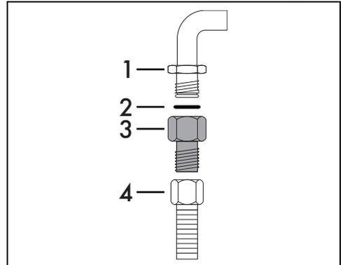
Vissez soigneusement le raccord 3 au raccord du gaz 1 (fileté  $\frac{1}{2}$ " ISO 228-1) de l'appareil en interposant toujours le joint 2 fourni. Appliquez du matériau isolant sur le filet du raccord 3, puis vissez le tuyau flexible en acier 4 au raccord 3.
